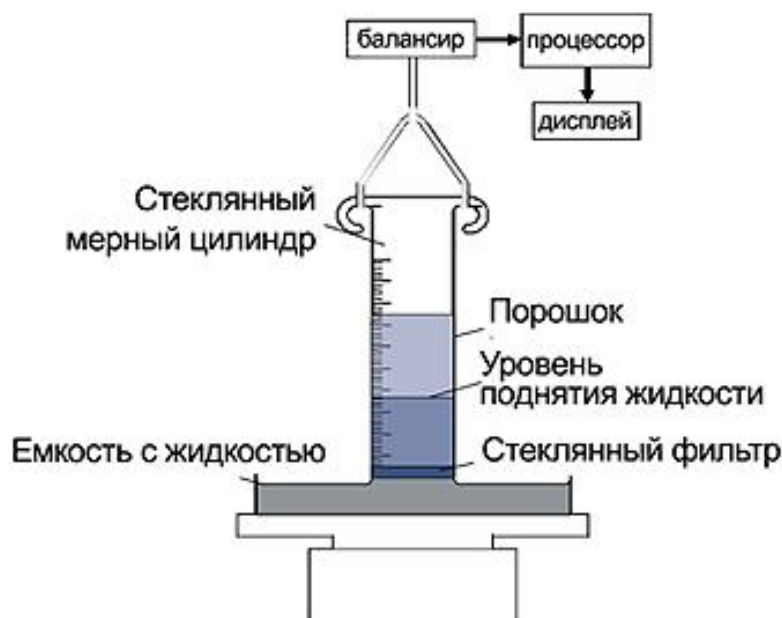
Рис. 9 - Метод поднятия по капилляру (Метод Вабуерна)
