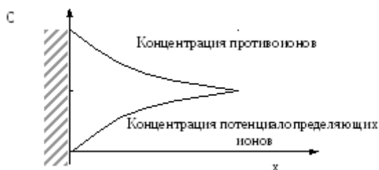
Рисунок 6 - Схема изменения концентрации ионов электролита с расстоянием x от поверхности частицы дисперсной фазы.
