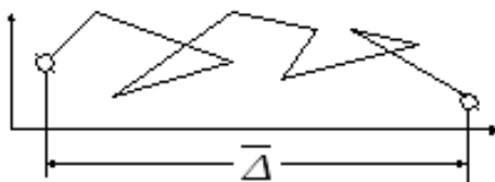
Рис. 1 - Схема броуновского движения частицы дисперсной системы
